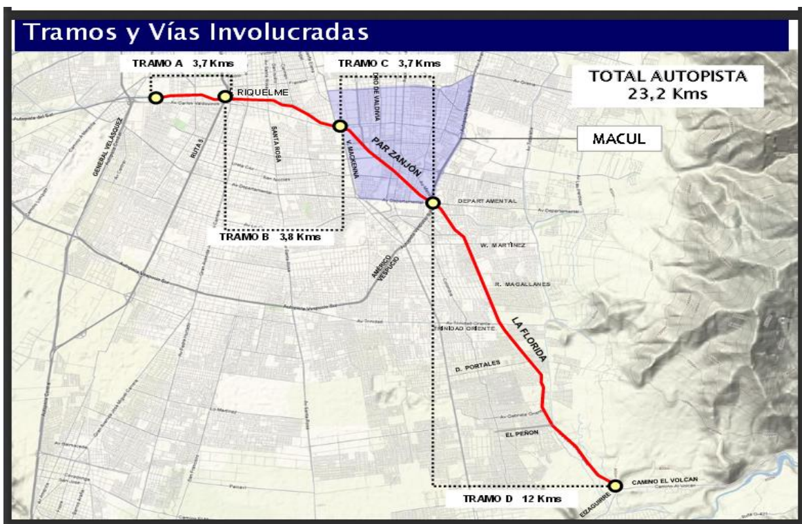
Imagen N° 2. Tramos y vías involucradas en la construcción de Autopista Costanera Central. Exposición OHL a Ilustre Municipalidad de Macul.
