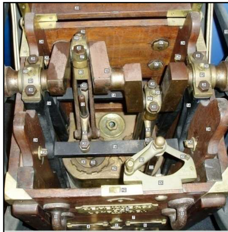
IMAGEN 6: Detalle bomba de aire Siebe & Gorman
