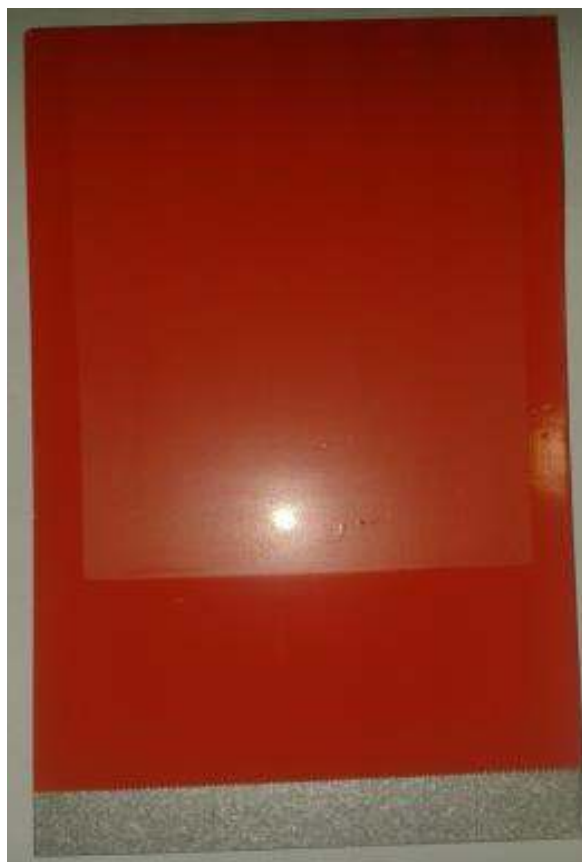
Fotografía 7: Placa 200 hrs. de exposición UV.
