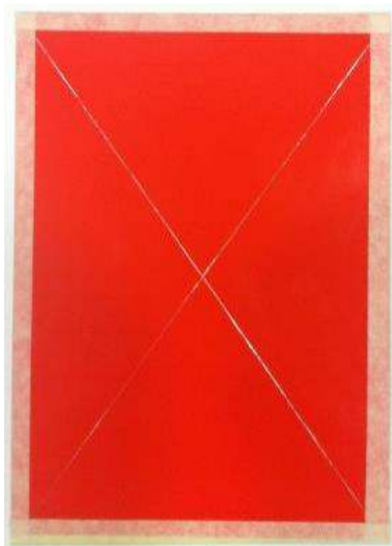
Fotografía 4: Placa al inicio del ensayo de Nieblas Salinas
