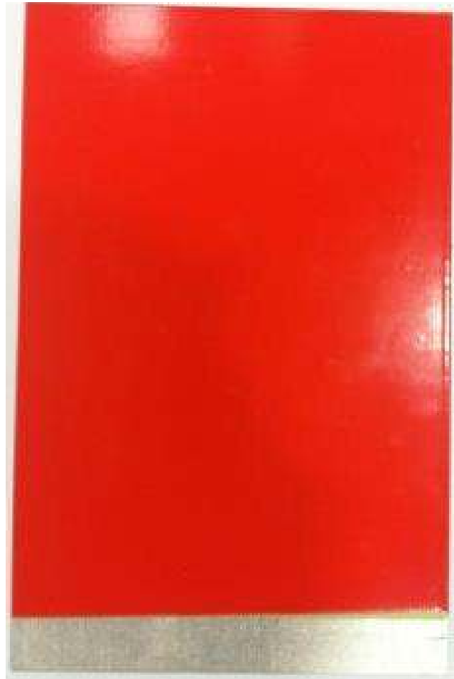
Fotografía 6: Placa al inicio del ensayo de irradiación UV
