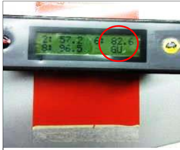
Fotografía 2: Ensayo verificación de brillo
