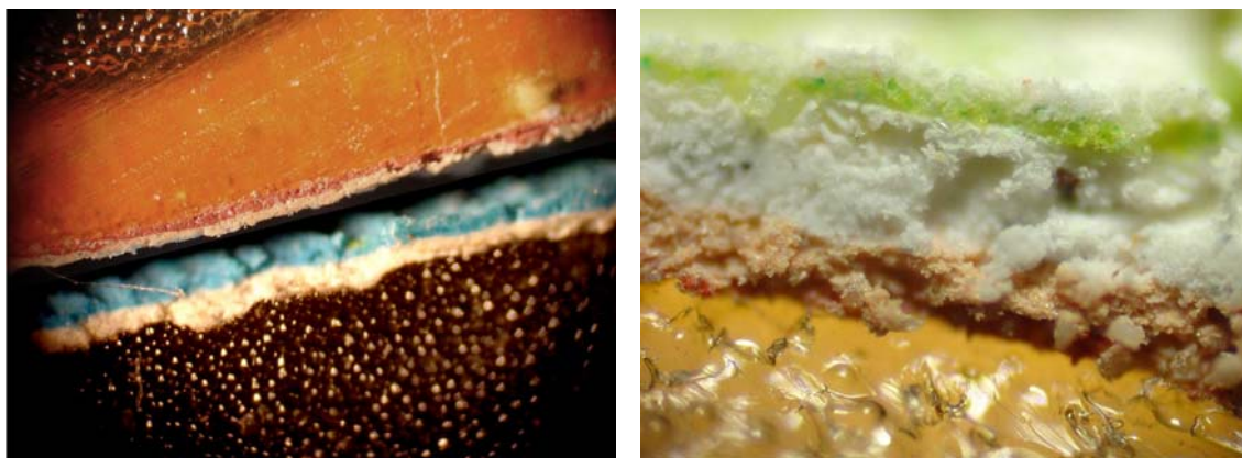
Análisis estratigráficos. Izquierda, muestras de abril de 2005, se aprecia: Capa de Preparación Mural (blanco), Pintura Mural (azul) y Repintes (naranja). Derecha, muestra posterior, se aprecia espesor de los repintes. Gentileza, archivo gráfico Francisco González Lineros.
