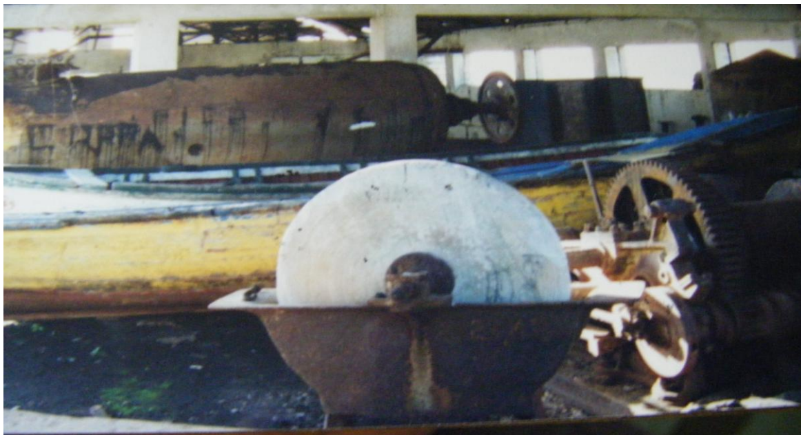
Figuras 19: Fotografía de las dependencias de la factoría, ya abandonada en el año 1996. Se ve en primer plano, un instrumento utilizado para afilar el espele. (Colección privada de Carlos Macaya).
