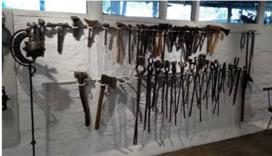
Imagen 30 Distintos tipos de tenazas de hierro forjado para trabajar en la fragua, junto a grifas, topes y martillos, tanto de exhibición como de uso.
