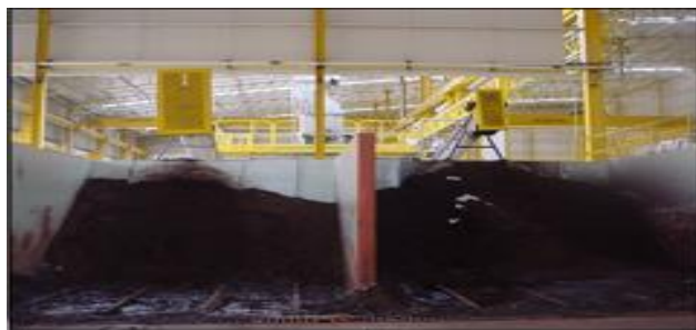
Figura 10: Almacenamiento de pasta de plomo.
