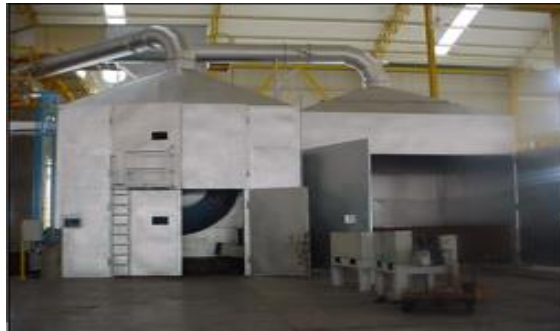
Figura 11: Fundición de pasta de plomo y saldos de plomo en horno rotatorio.
