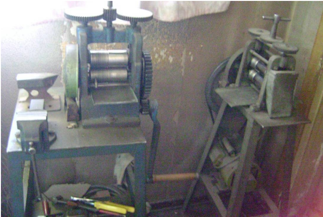
Ilustración 12: A la izquierda un laminador manual y otro eléctrico (lado derecho)
