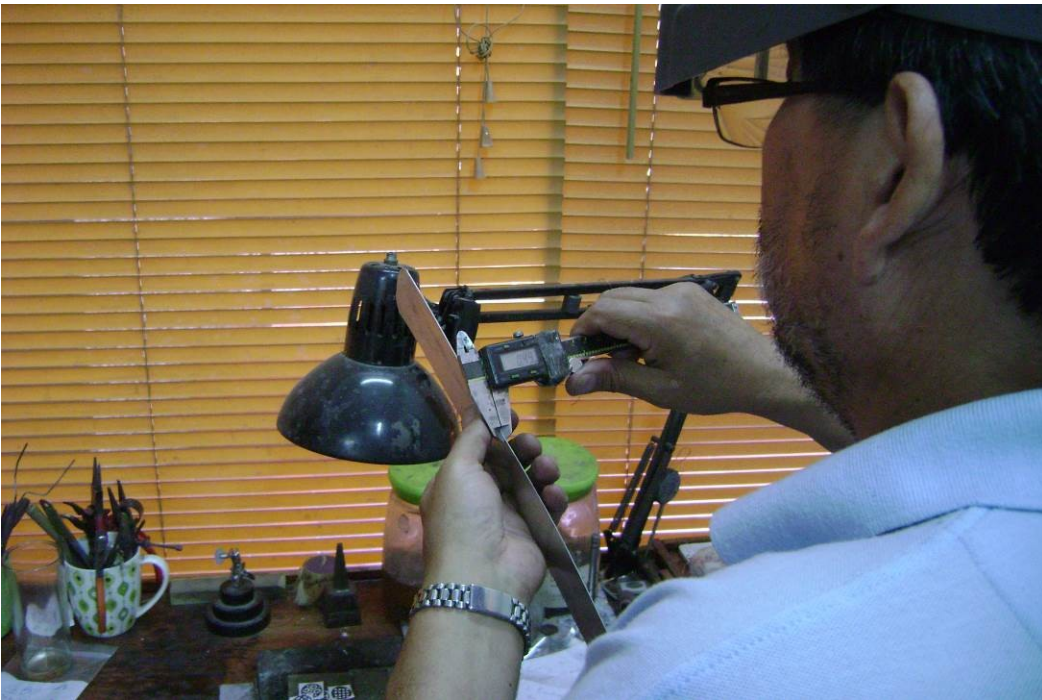
Ilustración 17: Midiendo con el pie de metro el espesor de la lámina que se necesita.
