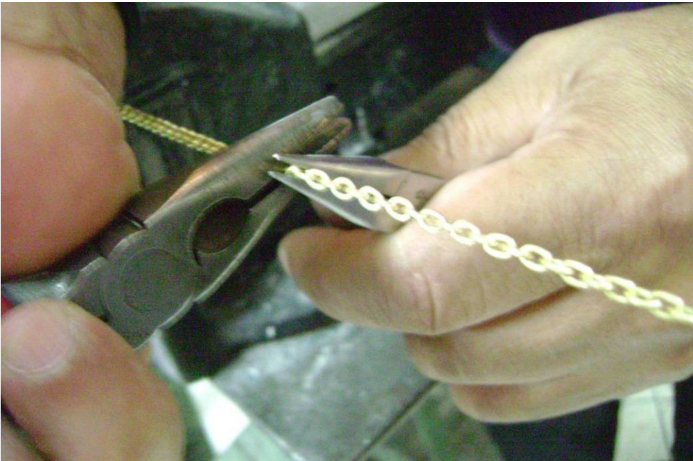
Ilustración 21: Torsión de la cadena por medio de los alicates.
