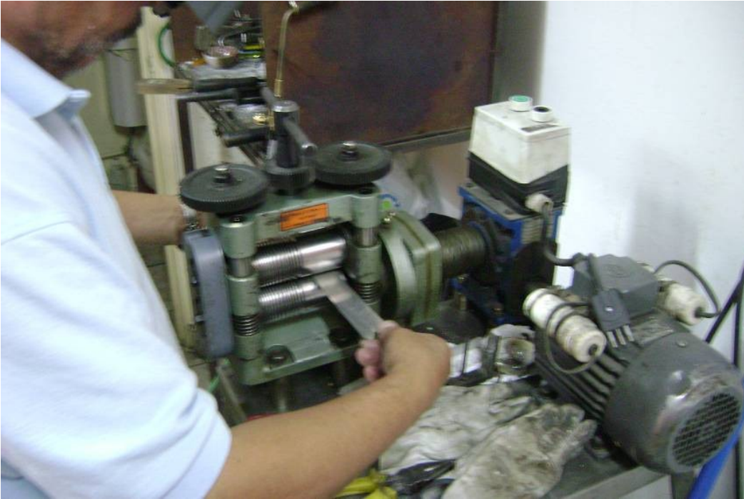
Ilustración 16: laminado de una chapa de plata.
