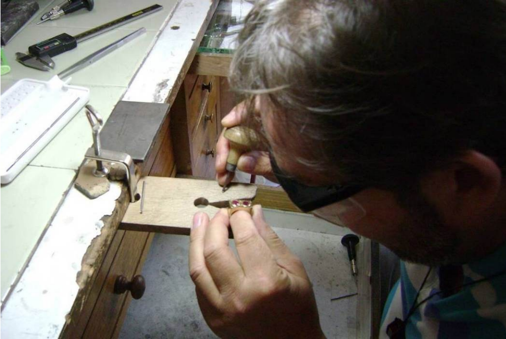
Ilustración 23: Joyero -engastador tomando un brillante por medio de un buril con cera en la punta.
