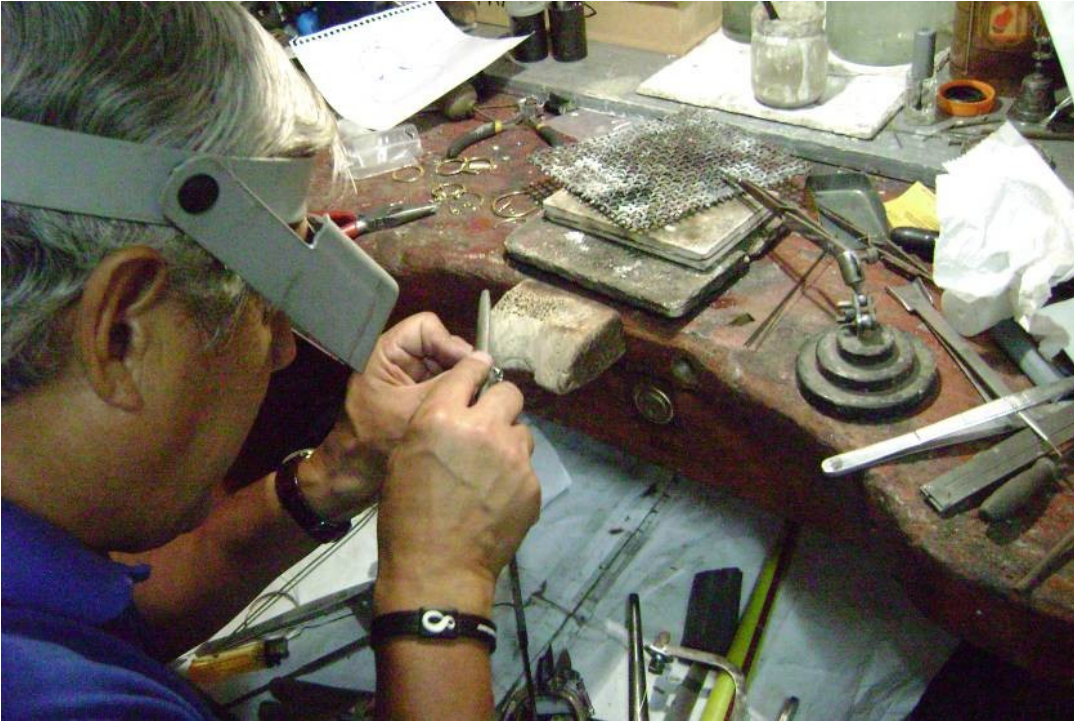
Ilustración 10: Joyero limando una pieza sobre la teca de su banco de trabajo y con la visera en la frente.
