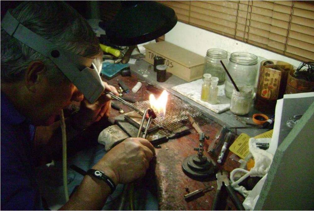
Ilustración 18: utilizando un soplete de boca, donde la manguera que sopla el joyero permite controlar y precisar la llama que fusionará las piezas.
