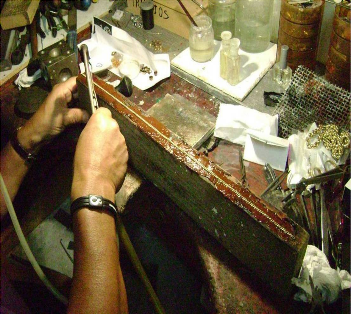
Ilustración 22: la cadena se deja sobre un palo con goma laca. Esta se calienta con el soplete de boca para fijar la cadena sobre el palo, y así poder limarla.
