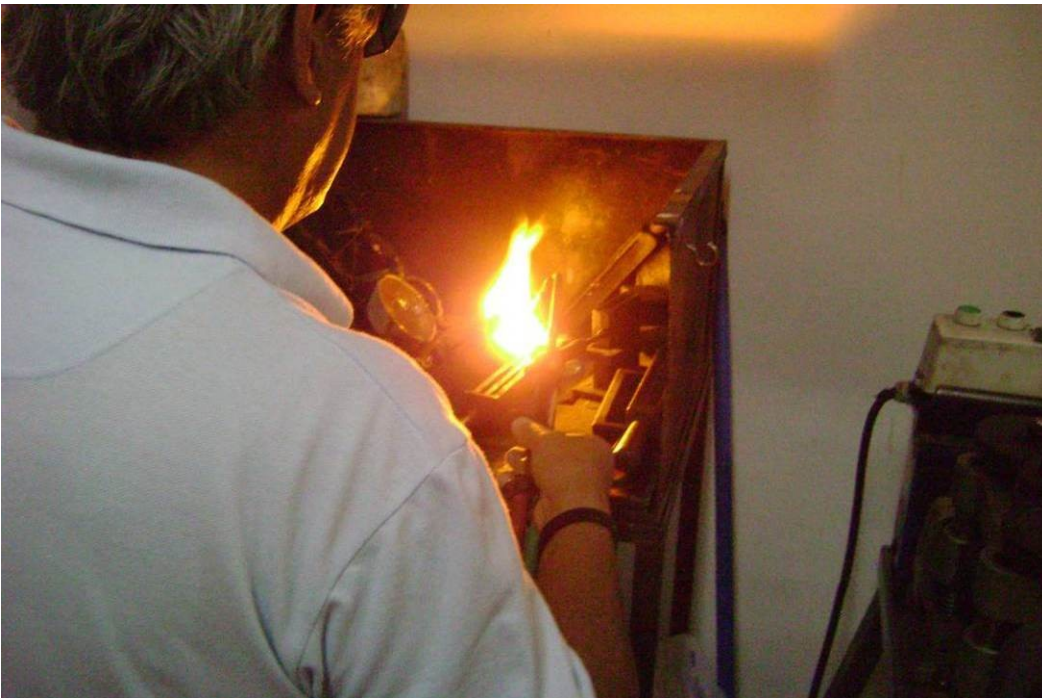
Ilustración 15: Vaciando el metal fundido en la lingotera.
