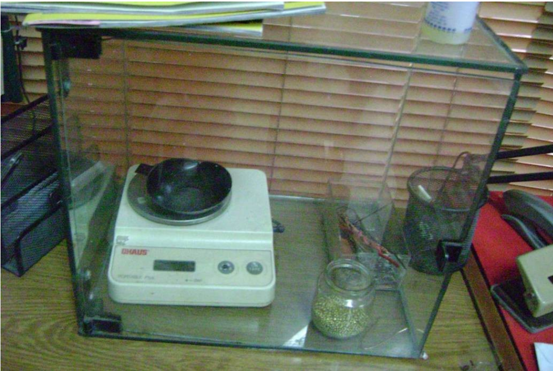
Ilustración 14: Pesa digital de joyería dentro de una estructura de vidrio, para protegese de las partículas de material y polvo que hay en el taller, evitando que se descalibre.
