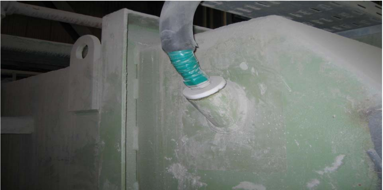
Fig. 41: Sistema supresor de polvo en el chute de descarga de una correa.
